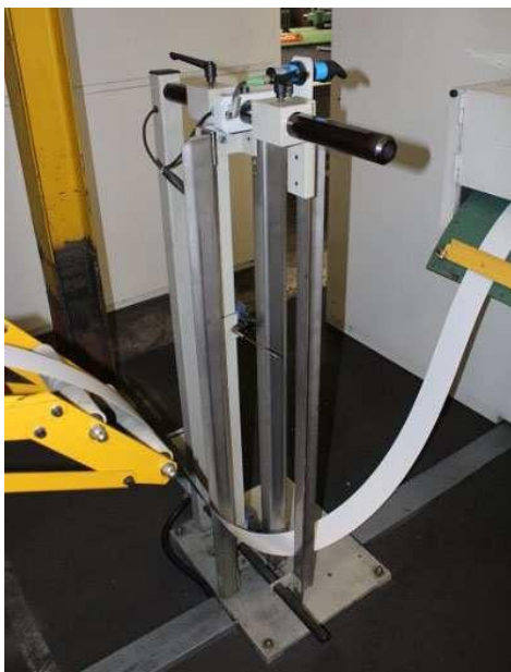
La bande se détend pour former l'accumulateur en boucle.
